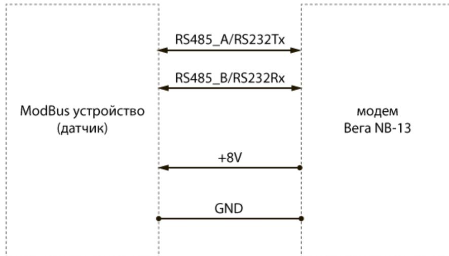
Модем может подпитать подключенное к нему ModBus устройство перед его опросом, для этого используется клемма «+8V».
